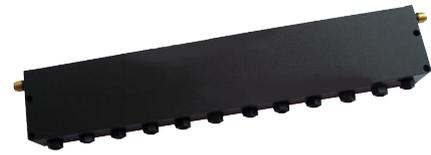
该大洋带阻滤波器（OBR）的产品名称是OBR-2595-190, 阻带频率为2500 ~ 2690MHz，阻带衰减为  $\geq 50\text{dB}$ , 通带频率为 DC ~ 2400MHz & 2790 ~ 5000MHz, 通带插入损耗为  $\leq 2.0\text{dB}$ . 其通带VSWR为  $\leq 1.7:1$
